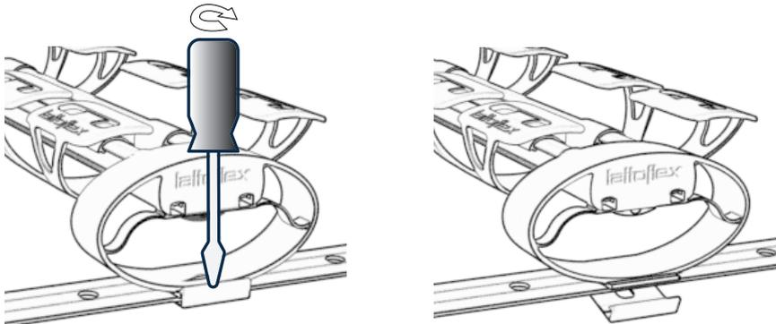
3. Zwei innenliegende Rasthaken an der Profilaufnahme gleichzeitig lösen. (siehe A und B).
